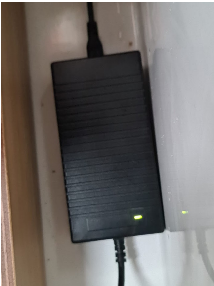
Ladegerät Batterie mit Kontrolllampe (grün Batterie voll, rot Batterie lädt)
