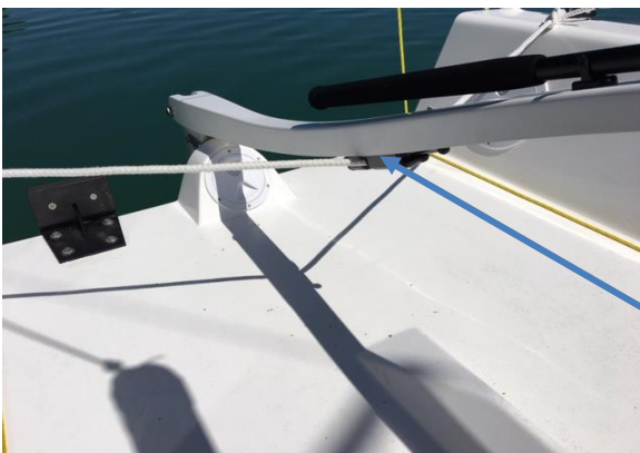
Befestigung der Pinne mit der weissen Arretierungsleine.
