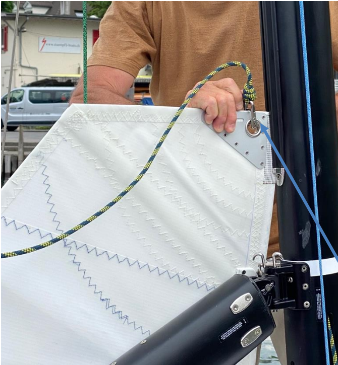
Befestigung Kopf Segel mit Schäkel am Grossfall
