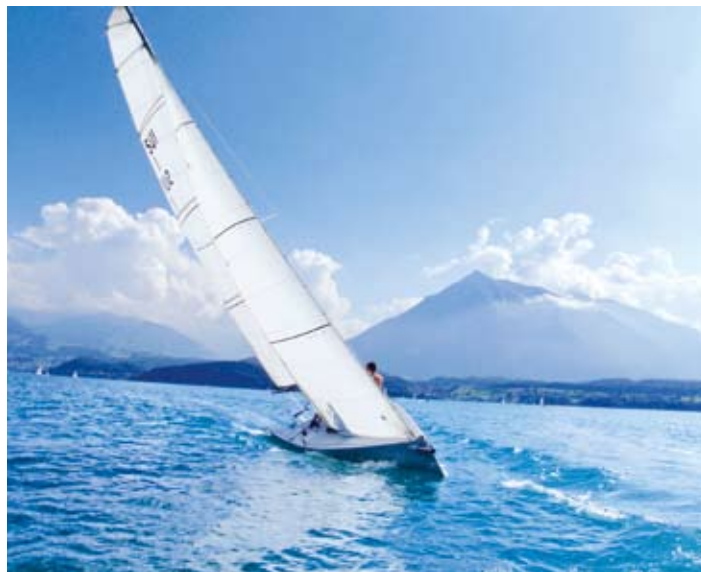
mOcean: Länge 7,97 m, Breite 2,20 m, Gross 22m 2 , Roll-Fock 15m 2 , Gennaker 68m 2 , Spi 65m 2 , Doppeltrapez, eingebauter Elektromotor. Foto: Sailbox
